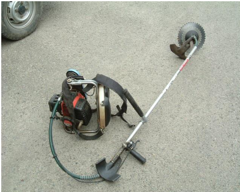
事故時に使用していた刈払い機
